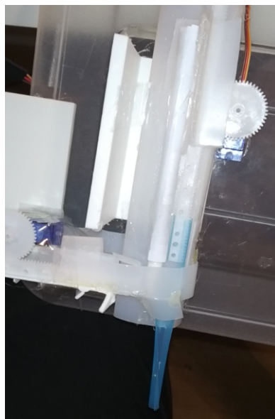
Prototyp pierwszej wersji mechanizmu dozownika opartego na przeciętych pionowo słomkach do napojów.
