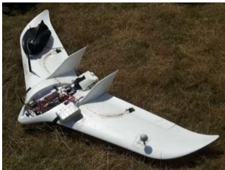
Zdjęcie 8 - początkowa wersja HAMAV'a z założonym wydrukiem stabilizującym na ogonie
